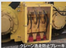
クレーン逸走防止ブレーキ
