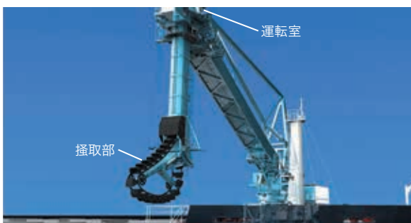
連続アンローダ全景
