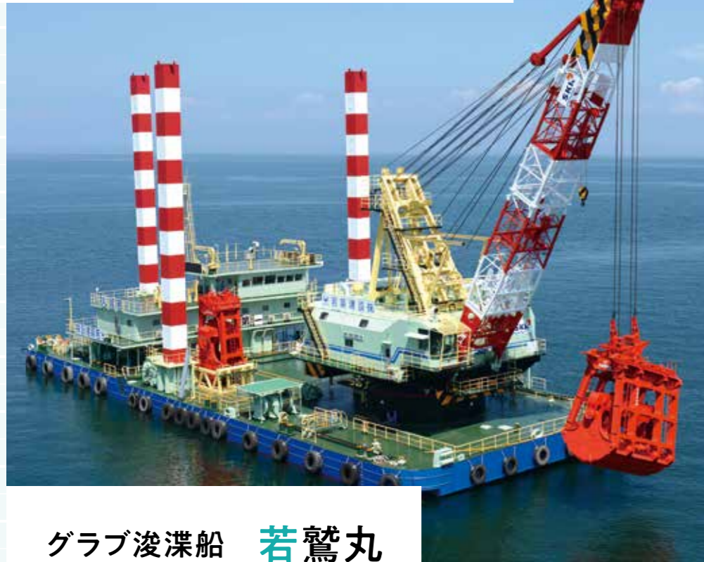
土砂を掴むグラブバケットは、重さが60tあり、一度に30m 3 (お風呂150杯分)の土砂をつかむことができます。
