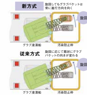
平行なグラブバケットで、掘り過ぎることを抑えるとともに、作業効率を向上させます。
