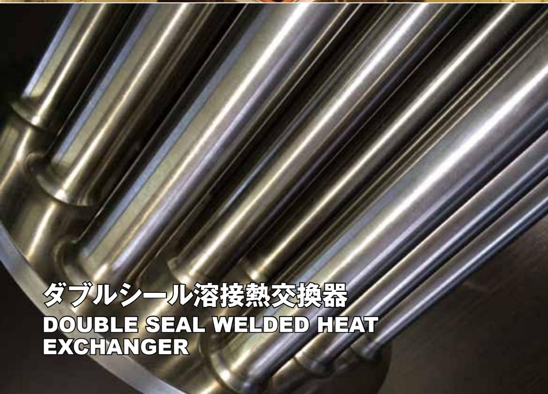
**ダブルシール溶接熱交換器**
