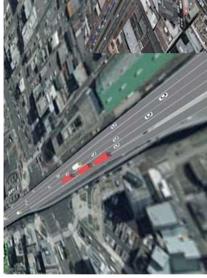
自動運転、トラック隊列走行モデルを組み込んだ交通シミュレーションモデル
