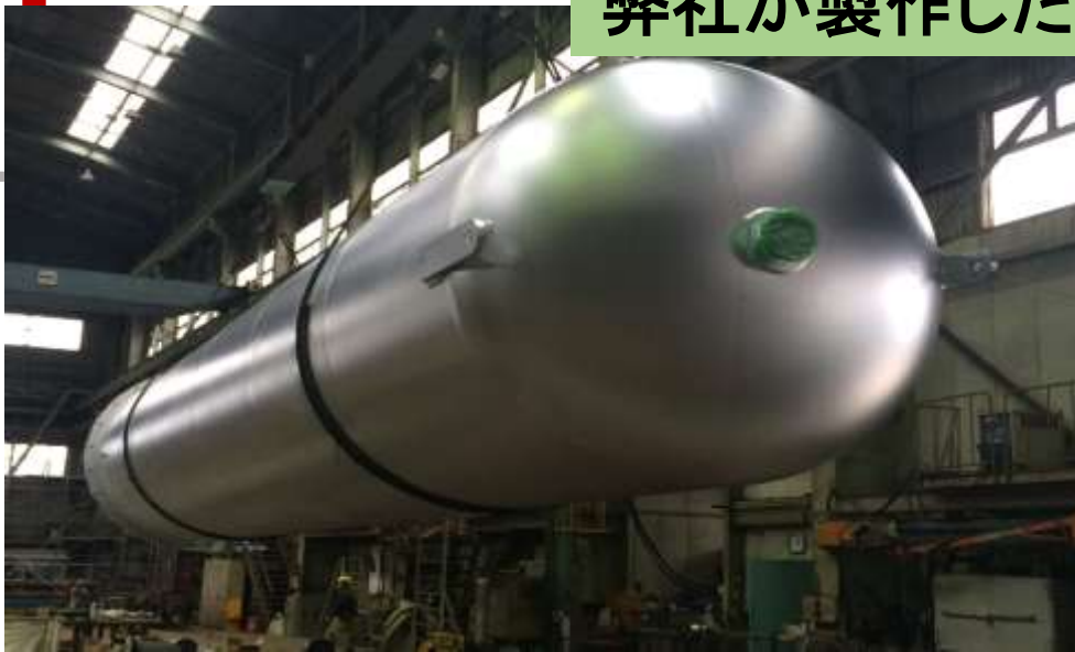
化学工場向け圧力容器（排ガスホルダー）
