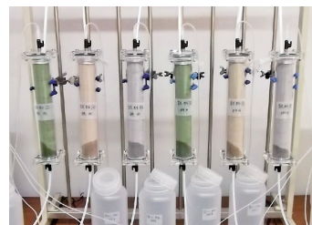
水処理用吸着剤の性能試験
