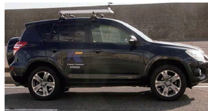
図3 走行型路面等調査車両
