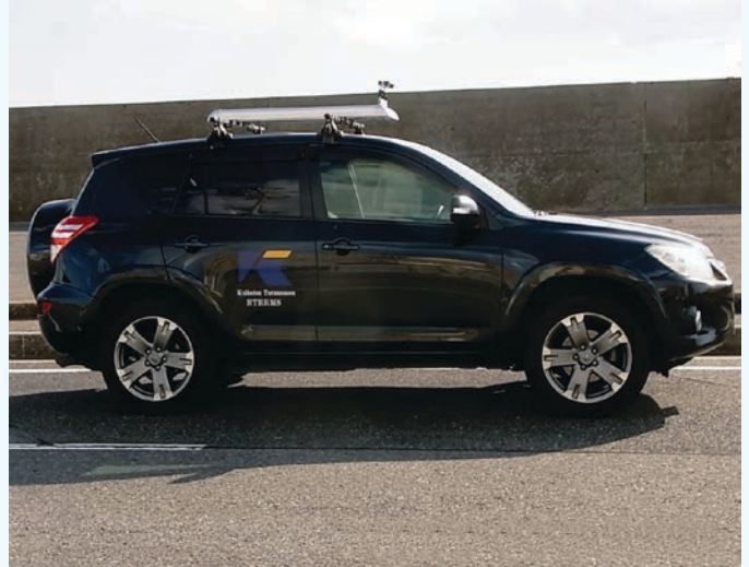
●路面下空洞調査(地中レーザー探査)〈兵庫県他〉
