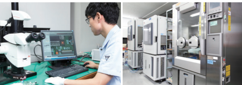
生産管理部門では各製品の受入れ検査や調査解析、協力工場への発注及び納期管理、電子部品や機構部品の調達購買、製造原価の管理及びコスト削減など、顧客への安定供給に努めます。 品質保証部門では各製品の運用を想定しハードウェアおよびファームウェアに関する厳しい評価試験を実施、高品質の維持管理に努めます(写真は信頼性試験室)。
