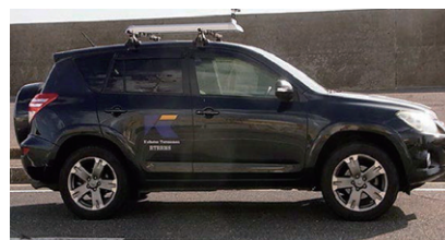
図3 走行型路面等調査車両
