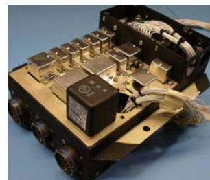
リレー・リレーパネル (Leach 社)
