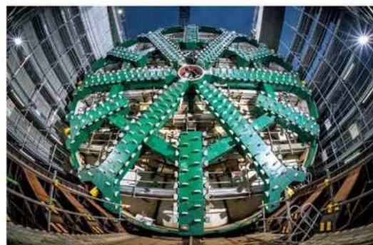
大断面地下トンネル掘削用シールドマシン
