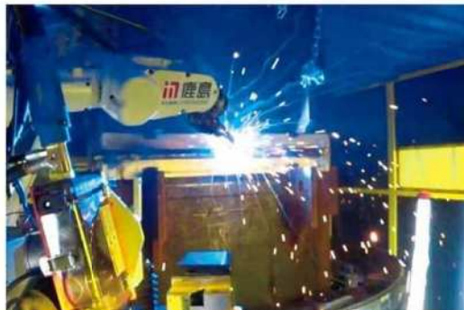
建設作業のロボット化(マニピュレータ型自動溶接ロボット)
